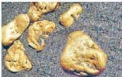
Рис. 38. Железомарганцевые конкреции ложа океанов
